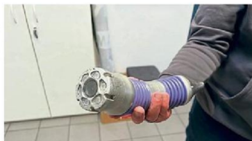
Mit ferngesteuerten Kamera wird im Rahmen einer „TV-Inspektion“ ein 3D-Modell eines Abwasserrohrs erstellt.
